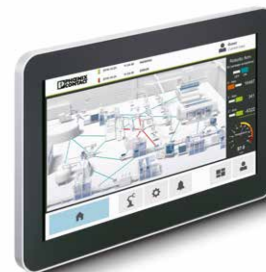
Afhængig af applikationen, fås AIO industri-pc'erne med display i størrelserne fra 15,6" til 21,5", altid med fuld HD opløsning
